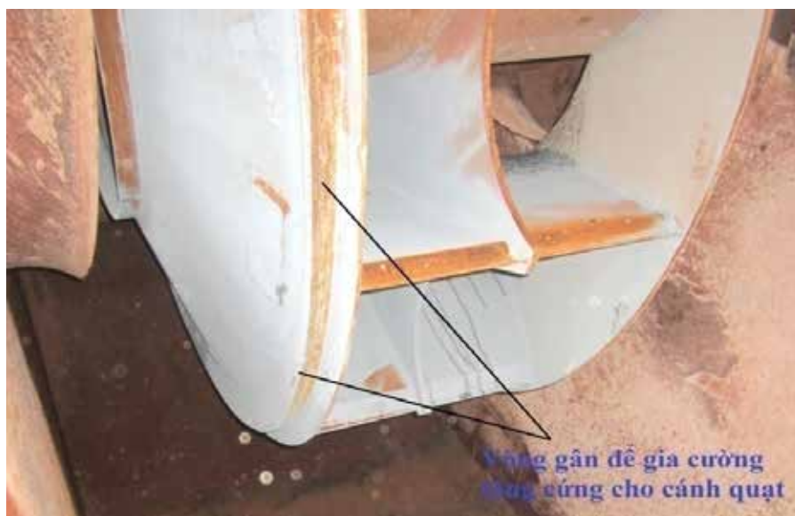
Hình 1. Hình ảnh cánh quạt FLS cấp bù đã được tăng cứng bằng vòng gân
