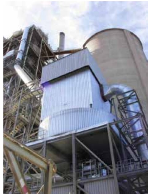
Hình 7: Nguyên lý làm việc của lọc bụi tĩnh điện nhờ hiệu ứng Corona (trái) và minh họa một EP điển hình (phải)
