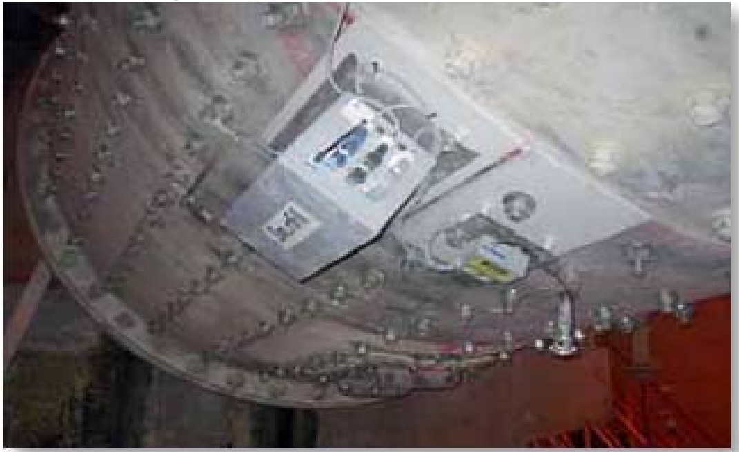
Hình 9: Hình minh họa chi máy nghiền bi với bộ đo lắp trên thân vỏ máy nghiền để đo mức đồ đầy và nhiệt độ
