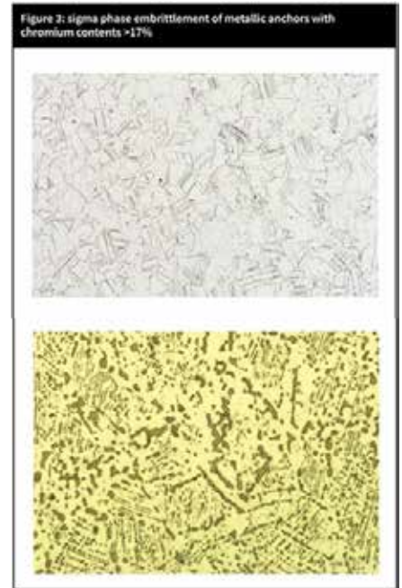
Hình 3: Tính dễ vỡ của pha sicma trong các neo thép kim loại có hàm lượng crôm >17%
