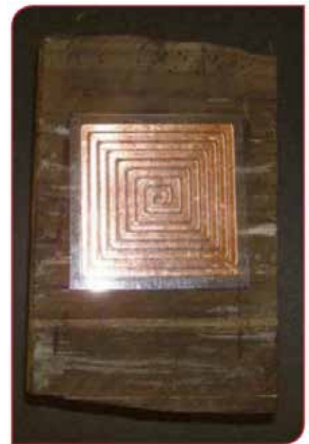
Hình 1: Bảng chứng về bộ cảm biến khái niệm được đặt trên một mẫu địa chất
